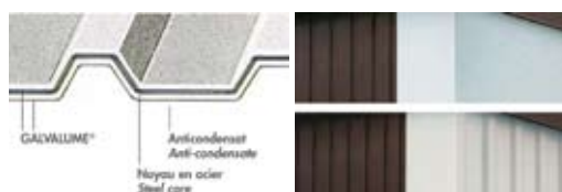
Copertura tetto in Galvalume®
